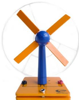
**Hinweis:** Das Fingerschutzgitter bietet Schutz vor einer seitlichen Kollision, zum Beispiel beim Drehen der Windturbine. Von vorn darf nicht in den Windrotor gegriffen werden, da Verletzungsgefahr besteht! Auch die Rotorblätter könnten beschädigt werden.
